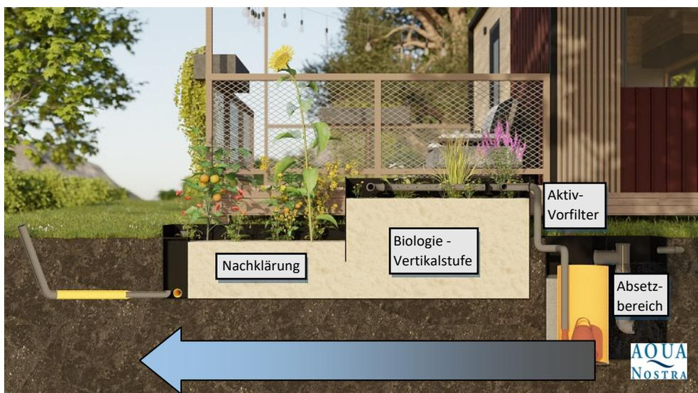
Das Grauwasser fließt aus einer Sammelleitung (HT DN 50) über die Vorreinigung (Stufe 1 und Stufe 2) der Grauwasserkläranlage Tiny-Hobbit in die Vertikalstufe (Stufe 3) und die Nachreinigung (Stufe 4).
