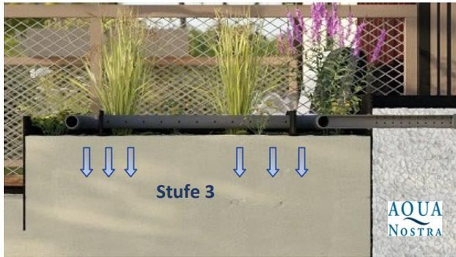
Die Biologie ist als ein Mehrschichtfilter aufgebaut, welcher vertikal durchströmt wird („Vertikalstufe“). Die oberste Schicht (10cm) besteht aus unserem für die Grauwasserbehandlung entwickeltem Spezialsubstrat GW 1K+. Dieses Substrat erhalten Sie mit der Kläranlage direkt von uns.
