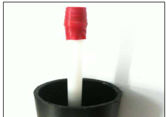
Farbige Markierung oberhalb der Oberkante des Führungsrohres
